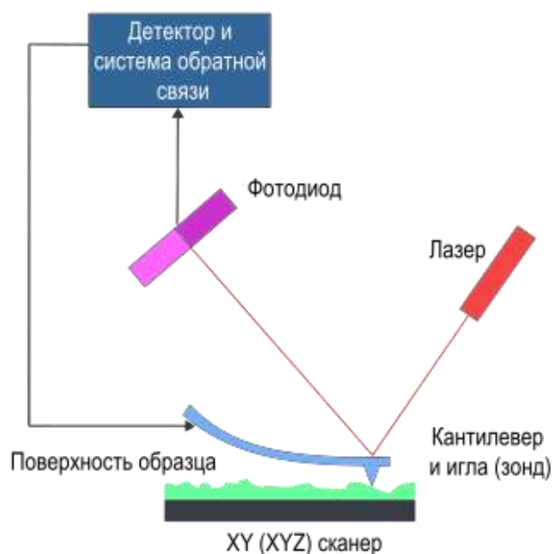
Рисунок 1 – Схема работы атомно-силового микроскопа [4]
