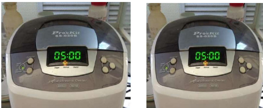
Рисунок 8 – Очистка пластины в ультразвуковой ванне
